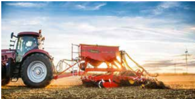
Рис. 2. Сівалка марки Rapid з висівними системами Spirit 400С
